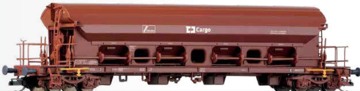
Schwenkdachwagen Tdgnss der CD Cargo
