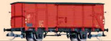
Ohne Bremserhaus, ohne Bremserbühne, mit Endfeldverstärkung
