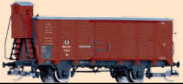
Kleines Bremserhaus, mit Endfeldverstärkung
