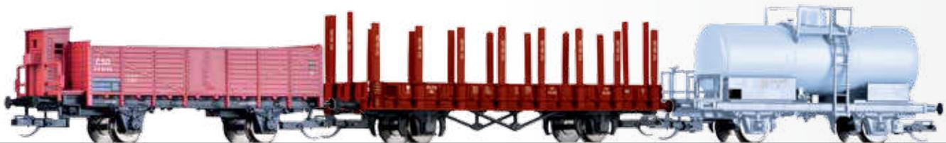
Güterwagenset, bestehend aus einem offenen Güterwagen der ČSD, einem Rungenwagen der PKP und einem Kesselwagen, eingestellt bei den SBB
